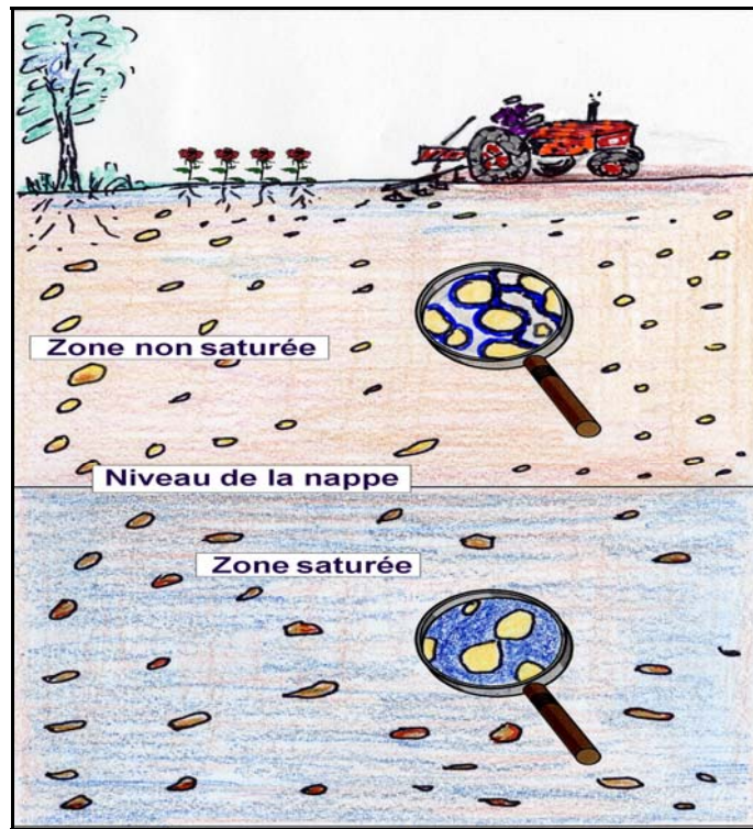
Illustration 31 - Zone saturée et non saturée dans un aquifère Source documentaire BRGM
