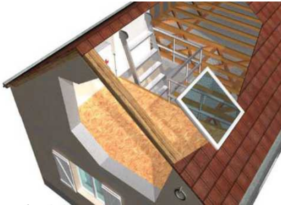
Schéma de principe d'un espace refuge.
