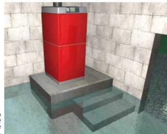
Protection d'un équipement de chauffage par surélévation.
