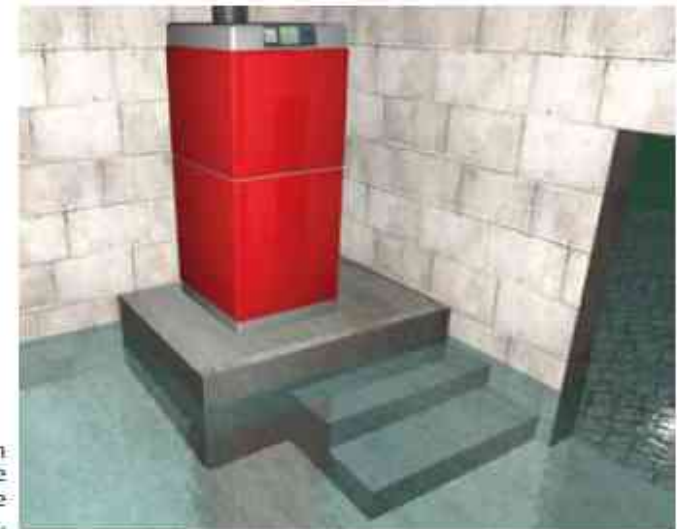
Protection d'un équipement de chauffage par surélévation.
