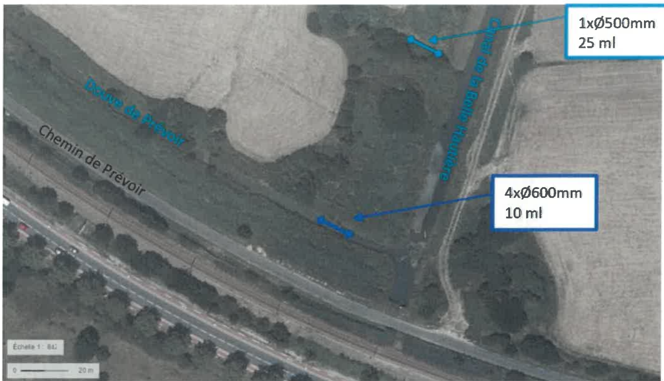
Figure 13 : Busages des axes hydrauliques partie sud du site
