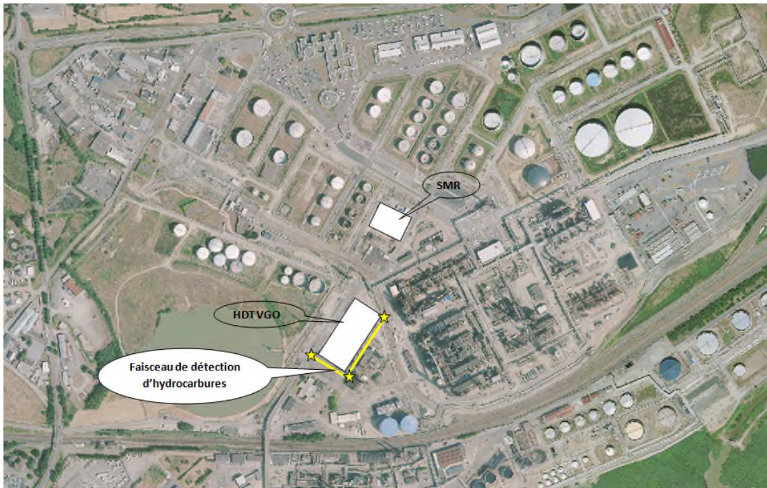
Figure 53 : Faisceau de détection mis en place par la Plateforme TOTAL dans le cadre du projet HORIZON après démarrage de l'unité HDT VGO (maintenu le temps du chantier de contournement SNCF)
