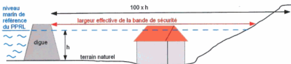
Calcul de la bande de précaution à l'arrière d'un ouvrage de protection.
