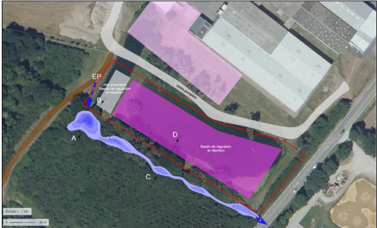
Fig. 14 : Plan d'implantation du nouveau bassin et localisation des aménagements à prévoir sur le fossé
