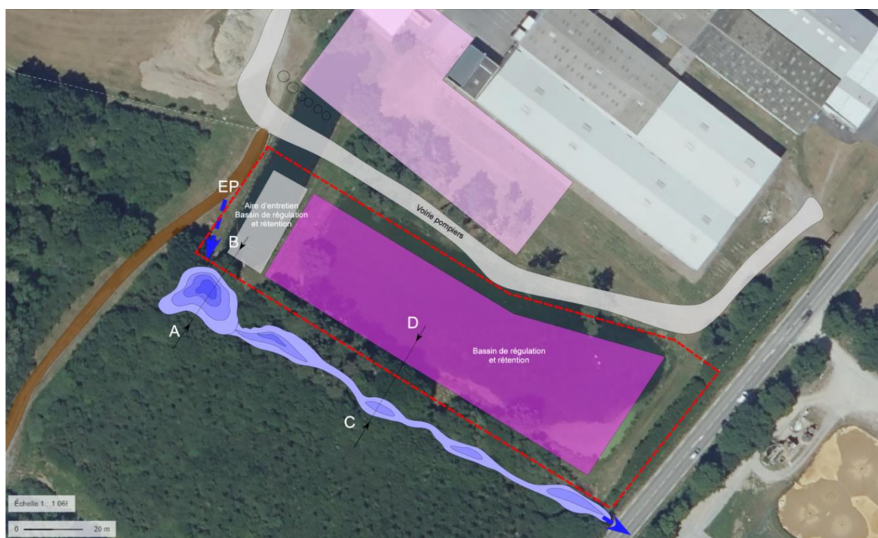
Plan d'implantation du bassin de régulation rétention et localisation de la mesure d'accompagnement
