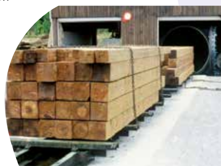
Procédé de traitement des bois par autoclave
