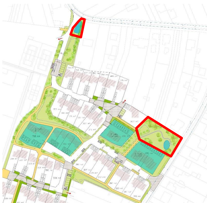
Figure 22 : Localisation de la mesure MR1 : balisage des secteurs de compensation durant la phase travaux (polygones rouges)
