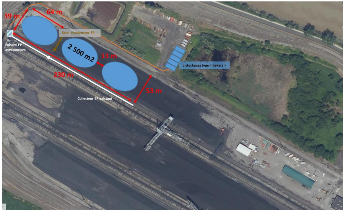
Figure 1 : Zone de stockage des granulés de biomasse et système de collecte des eaux pluviales non-conformes
