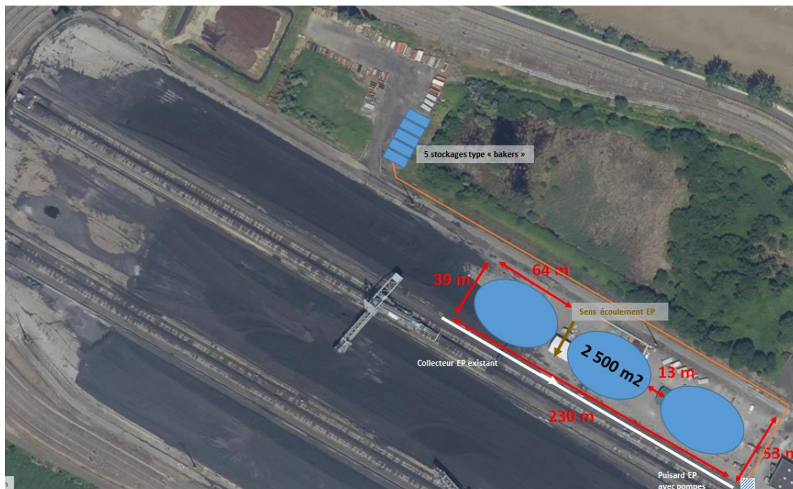
Figure 8: Nouvelle implantation du stockage de granulés de biomasse et circuit de pompage des effluents non-conformes
