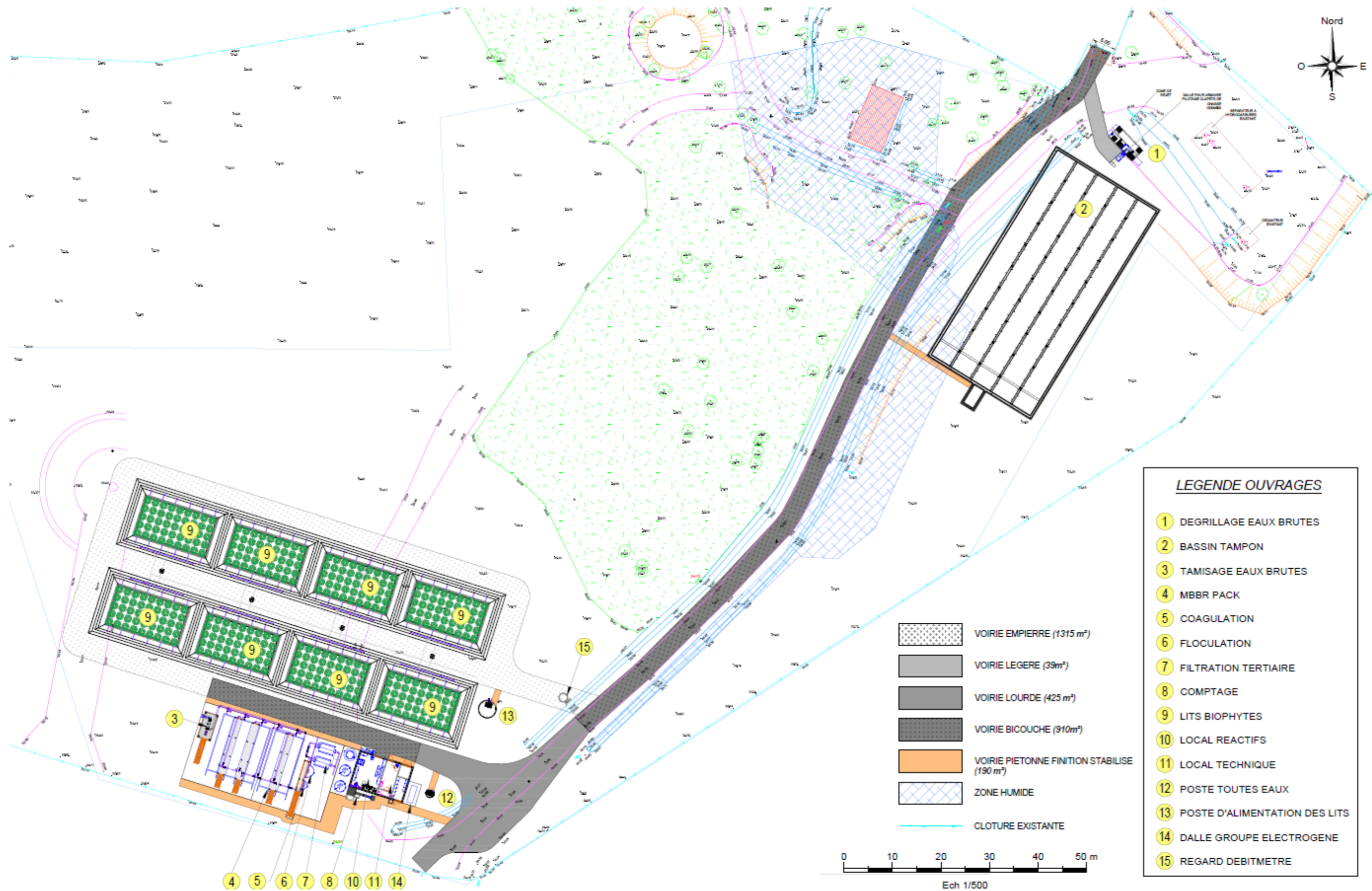
FIGURE 13 – STATION DE TRAITEMENT DES EAUX PLUVIALES DU BV1 AU TERTRE
